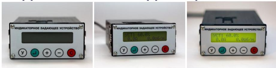
Индикаторное задающее устройство ИЗУ предназначено для работы в качестве выносного дистанционного пульта управления и индикации параметров работы преобразователя частоты (инвертора).
